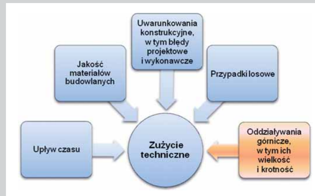
Rys. 1. Zestaw czynników odpowiadających za zużycie techniczne obiektu budowlanego na terenie górniczym.
